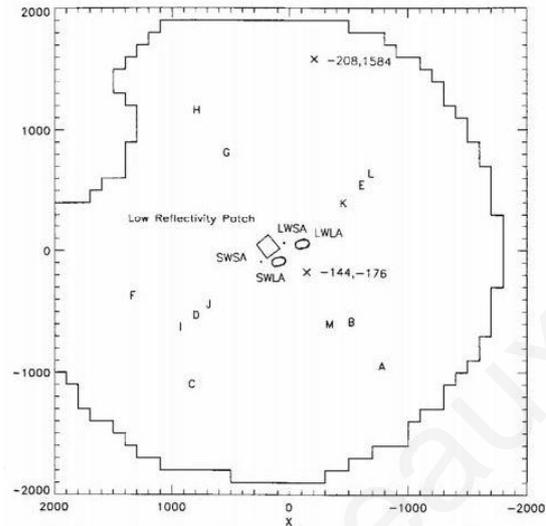
*Schéma du miroir de champ au foyer Cassegrain du télescope avec indication des fentes d'entrée des spectrographes et des marques de calibration.
