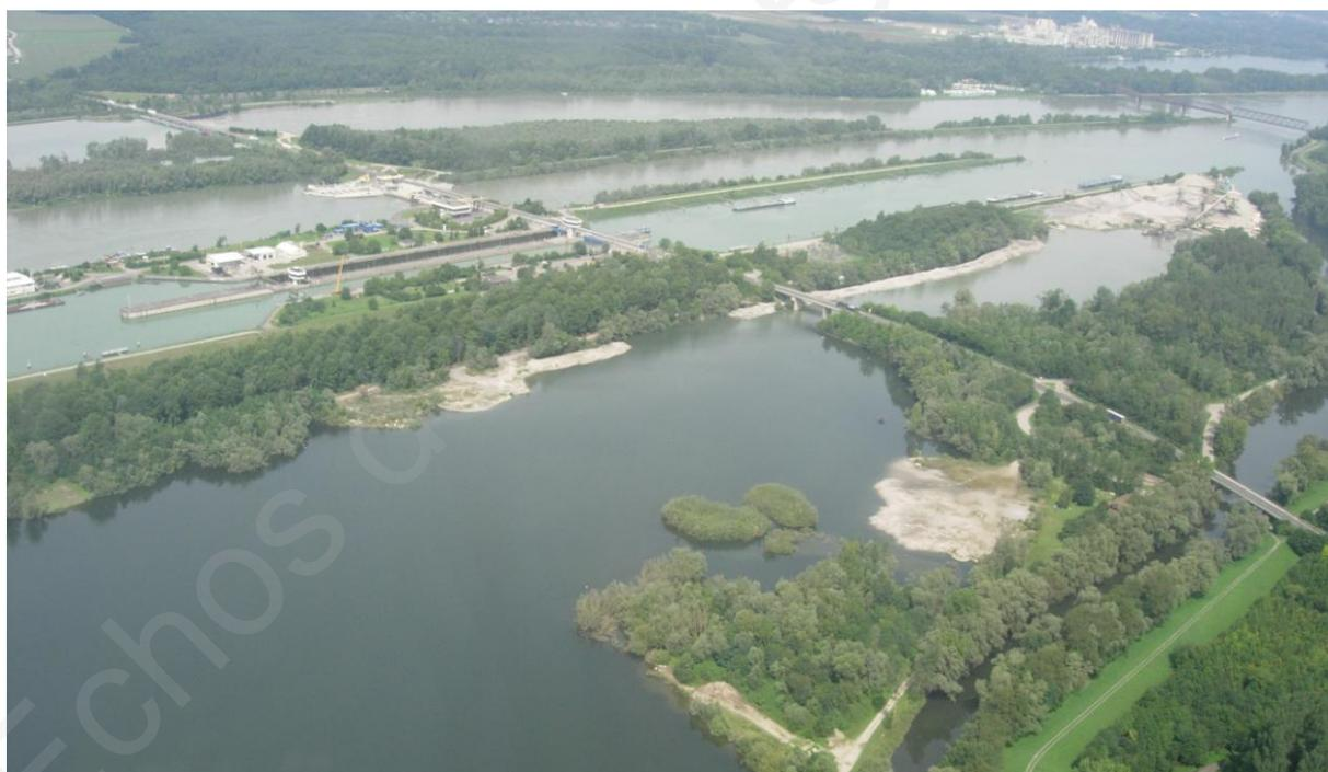
*Le complexe de l'écluse d'Iffezheim (quart haut gauche) photographié depuis un Junkers 52 en août 2014<sup>12</sup>. On distingue très bien la voie navigable canalisée de part et d'autre de l'écluse et entre des plans d'eau témoignant des anciens méandres du Rhin. L'ouvrage d'art abrite également une centrale électrique et une échelle à poissons permettant aux saumons de remonter le fleuve.*
