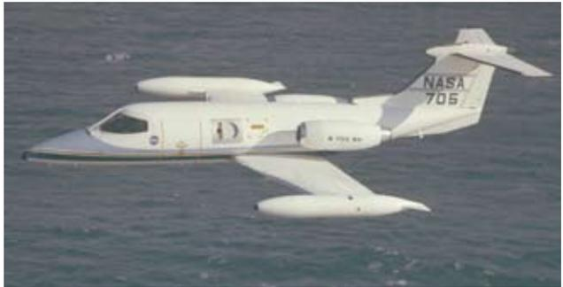
**2. Le Lear Jet 24B équipé d’un télescope stabilisé de 12 pouces (30,5 cm) conçu pour la recherche dans l’infrarouge et en contact direct avec l’atmosphère.**
