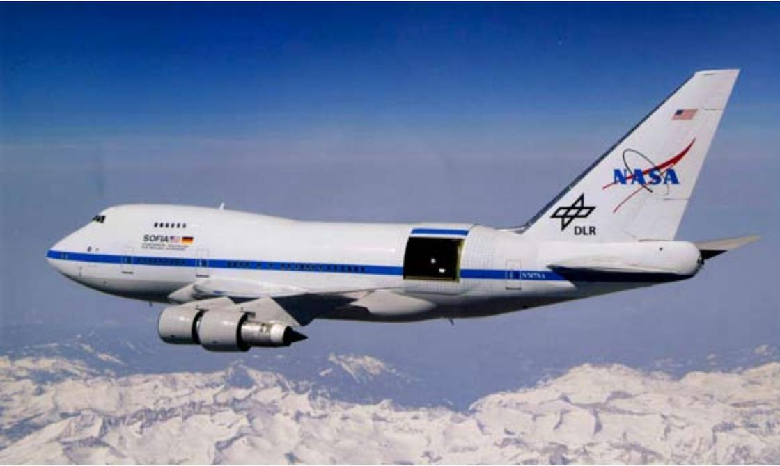
construit par l'agence spatiale allemande DLR recevant en échange 20% du temps d'observation à bord de l'appareil. La monture fut conçue pour isoler le télescope des vibrations induites par le vol. La stabilité du guidage est assurée par un système de gyroscopes, de caméras rapides et de roues d'inertie. Le projet fut baptisé *Stratospheric Observatory For Infrared Astronomy* (SOFIA) – observatoire stratosphérique pour l'astronomie infrarouge. On lui envisage une vingtaine d'années d'opérations.
