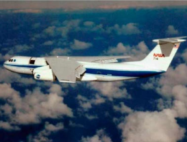
**3. Le Kuiper Airborne Observatory (un Lockheed C141 Starlifter) équipé d'un télescope de 36" (91,5 cm) en contact direct avec la stratosphère par la trappe visible en avant de l'aile gauche. (© NASA)**
